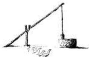
Puits à balancier permet l'accès à la nappe d'eau peu profonde.
