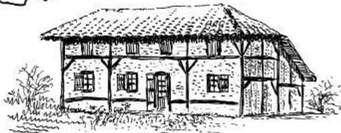
Born Toit à 4 pentes, façade sur un des longs murs. Les briques posées en arêtes de poisson sont couvertes d'enduit. Un ciên protège le mur le plus exposé.
