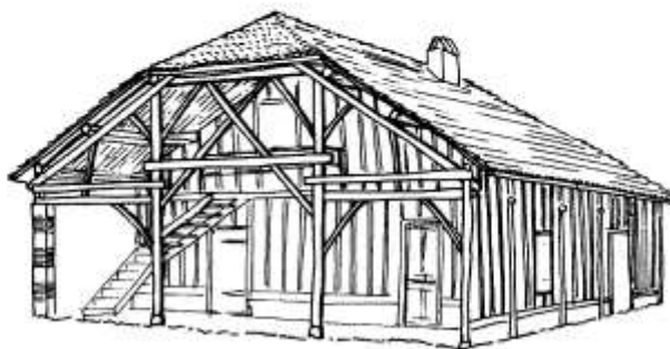
Gabardan Toit à 3 eaux et parfois un "pan-coupé" sur la façade. L'escalier sous l'auvent permet l'accès au 1er étage. Torchis pour les murs et "tout-venant" pour le soubassement sont les plus fréquents.
